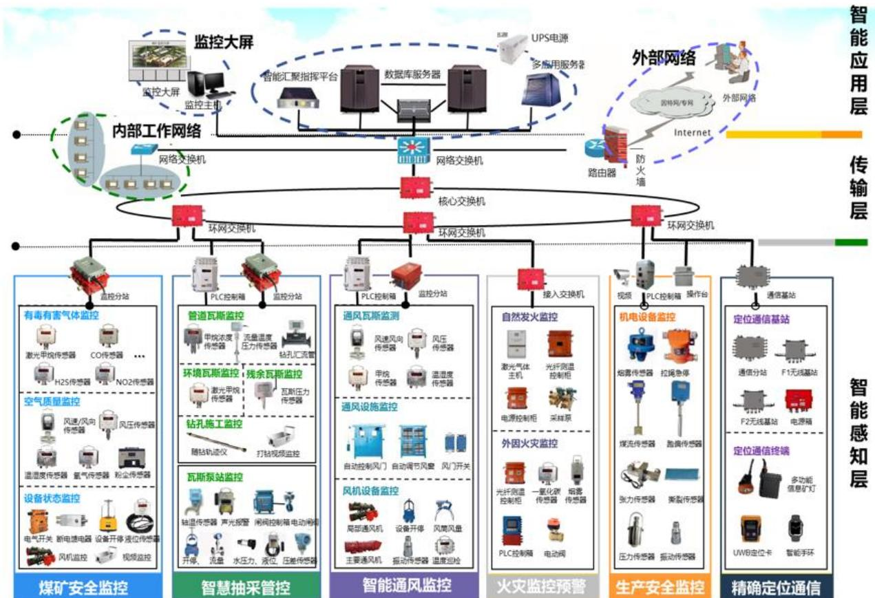
矿山安全生产监控系统基于大数据分析技术实现对井下异常的自动分析和超前感知，融合人员定位、应急监控、火灾监控等系统，实现多系统融合下的多业务异常联动处置，使安全监控系统真正实现自动化、智能化、可视化和集成化。系统还可进行人工远程控制，提升维护人员工作效率，为矿山安全生产、减员增效保驾护航。
