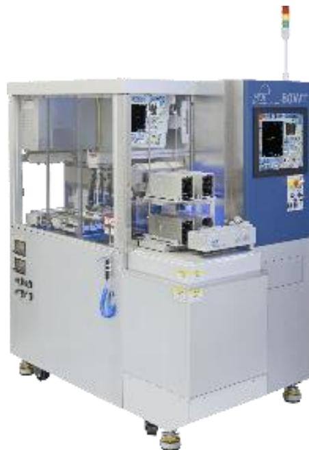
Wettable QFN 是针对汽车电子中对 QFN 封装芯片的焊接可靠性和可检视性的要求发展出的新型的封装结构，可以提供更高的焊接良率和更方便的可视化检测。80WT 适用于 wettable QFN 等对切割深度控制要求高的产品，大型封装基板的阶梯定深切割等场景。80WT 已通过全球头部封测企业日月光等客户端验证，产品性能得到客户的高度认可并形成订单。
